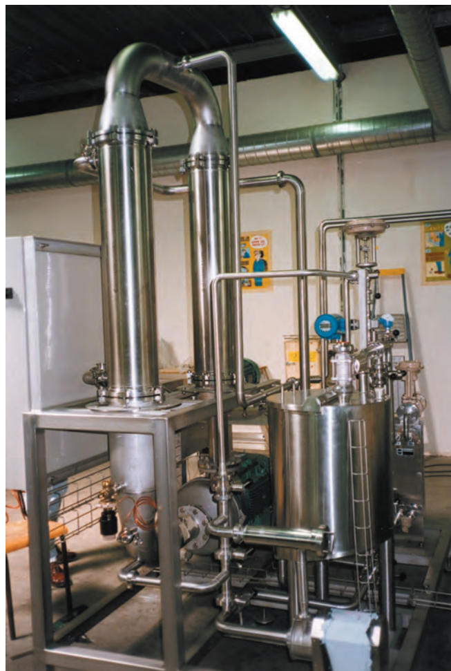
Figure 1 – Pilote industriel de microfiltration (source INRA)
