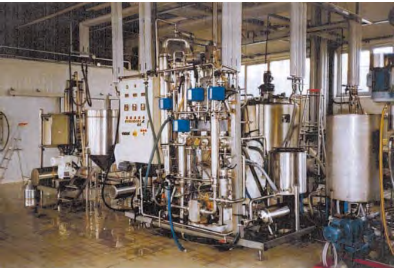
Figure 10 – Équipement pilote d'ultrafiltration de lait coagulé (source INRA)
